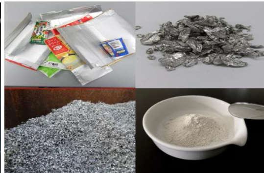
原料となる廃アルミの例と副生する水酸化アルミニウム
